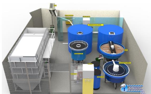
Ilustración 9 - Tratamiento de Aguas Lluvias no domésticas PTARND
