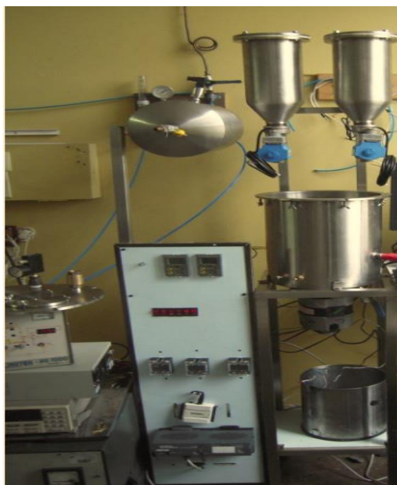
Ilustración 4 Biodigestor anaerobio completo.
