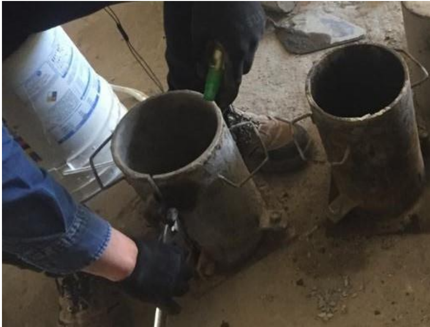
Figura 55. Camisas para la construcción de pruebas de concreto.
