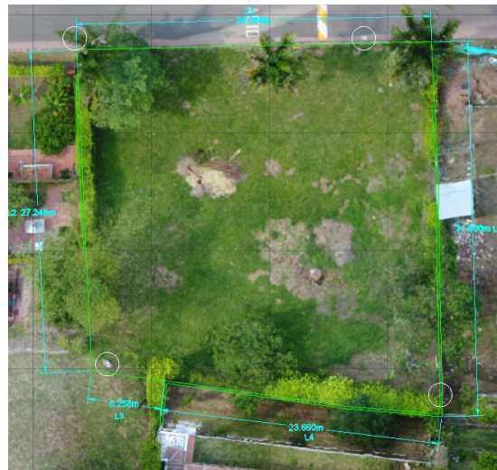
Figura 45. Plano de levantamiento del terreno con dron.
