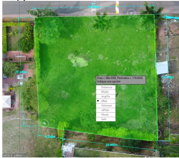
Figura 46. Estimación área y perímetro levantamiento con dron.
