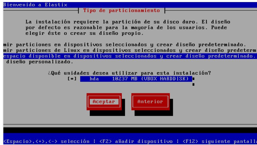
Figura 98. Instalación Elastix selección de partición Fuente: Autores
