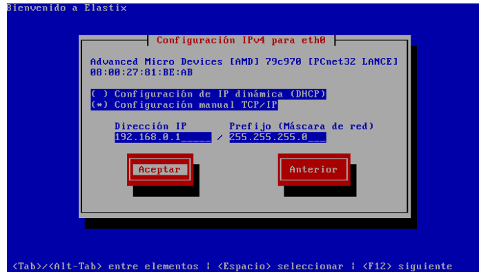
Figura 99. Instalación Elastix configuración interfaz de red Fuente: Autores
