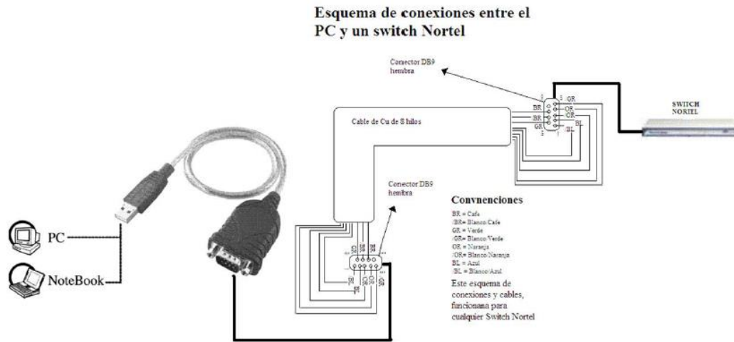
Figura 84. Conexión serial switch Avaya Fuente: Autores
