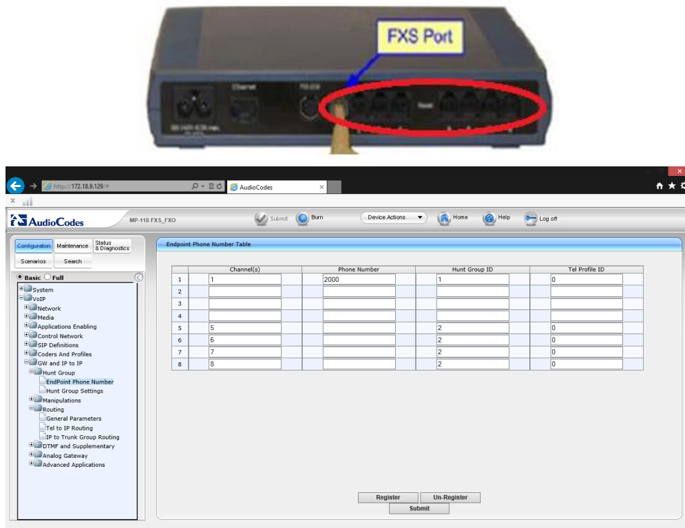
Figura 75. AudioCodes configuración extensión analoga. Fuente: Autores
