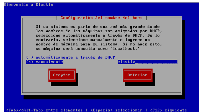
Figura 100. Instalación Elastix configuración nombre del servidor Fuente: Autores
