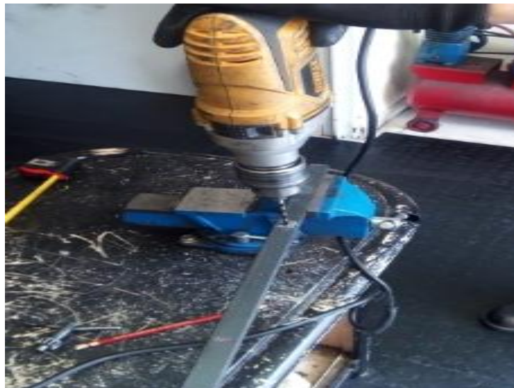
Figura 34. Perforación de Rieles
