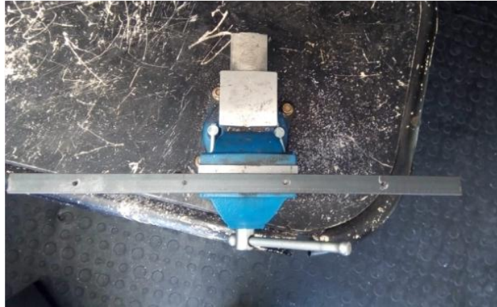
Figura 35. Rieles Perforados Listos para Remachar
