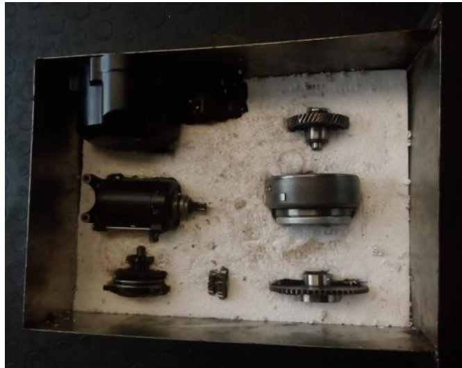
Figura 44. Acoplamiento de Piezas al Molde de Icopor
