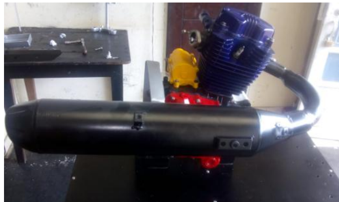
Figura 92. Fijación de Escape al Motor
