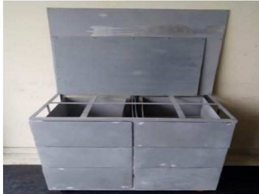
Figura 67. Banco y Tapas con Anticorrosivo.
