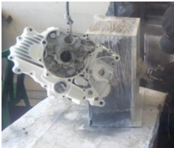
Figura 83. Proceso de Pintado parte Central del Motor y su Cajón.
