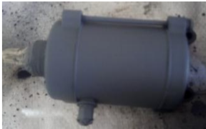
Figura 81. Aplicado Anticorrosivo Motor de Arranque.
