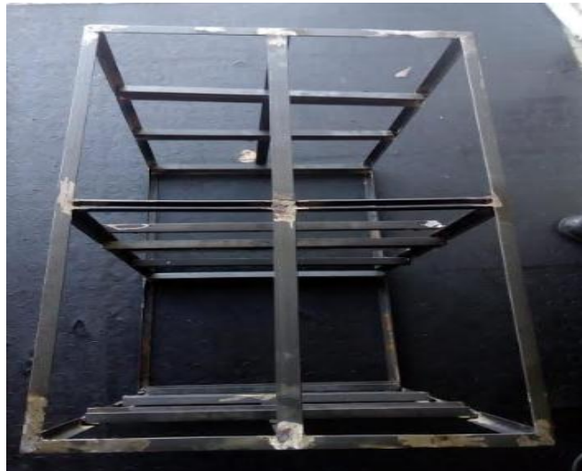
Figura 23. Reforzado parte Superior
