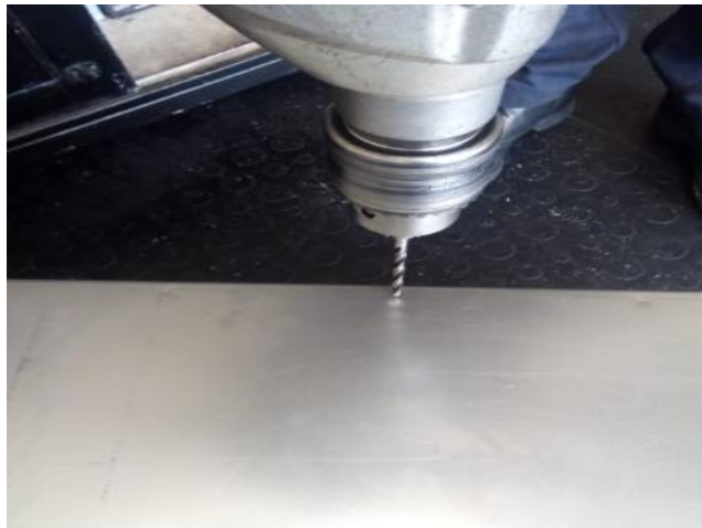
Figura 36. Perforación de Tapas Laterales de Cajones.
