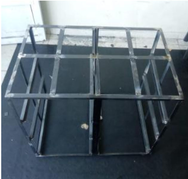
Figura 24. Reforzado parte Superior
