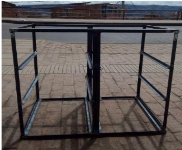
Figura 22. Chasis con Rieles Instalados.
