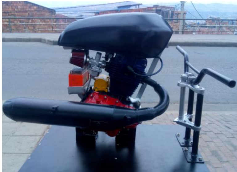
Figura 101. Instalación Final Sistema de Dirección.
