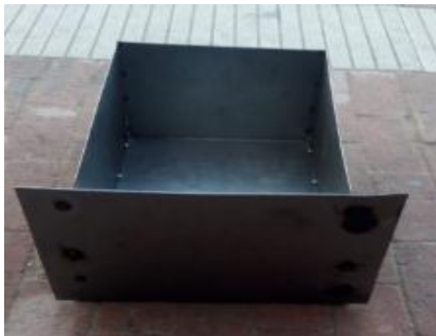
Figura 32 Cajón 1 con soldadura completa
