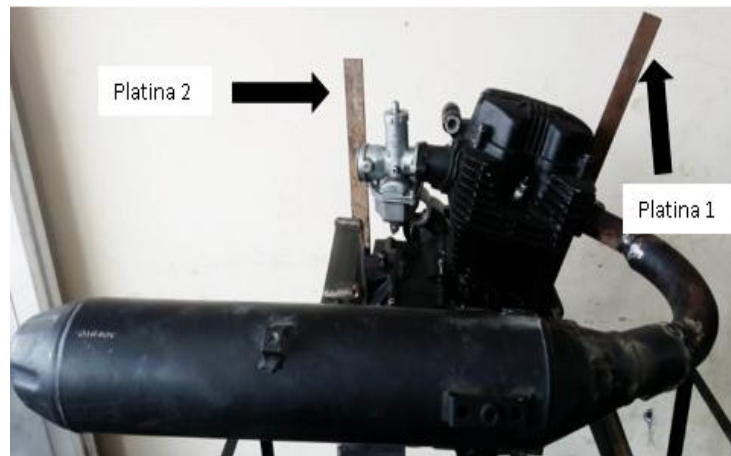
Figura 56. Instalación de Platinas al Motor.
