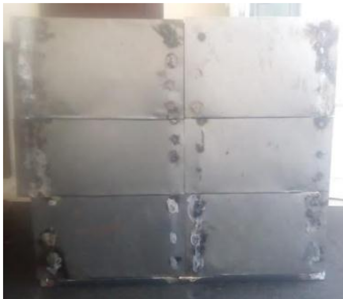
Figura 38. Chasis de Banco con Cajones Montados
