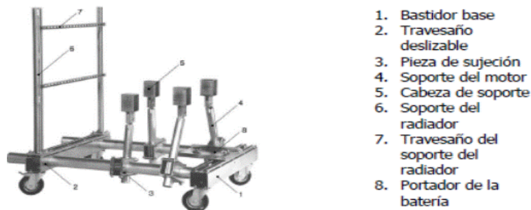
Figura 1. Ilustración Estructura Banco de Pruebas
