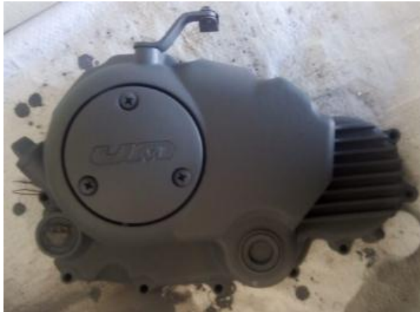
Figura 78. Aplicado de Anticorrosivo Tapa Clutch.
