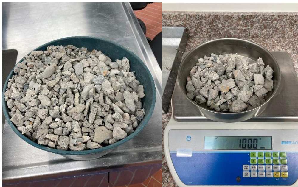
Ilustración 9-5. Muestra de RCD triturada lista para ser tamizada Fuente: Elaboración Propia
