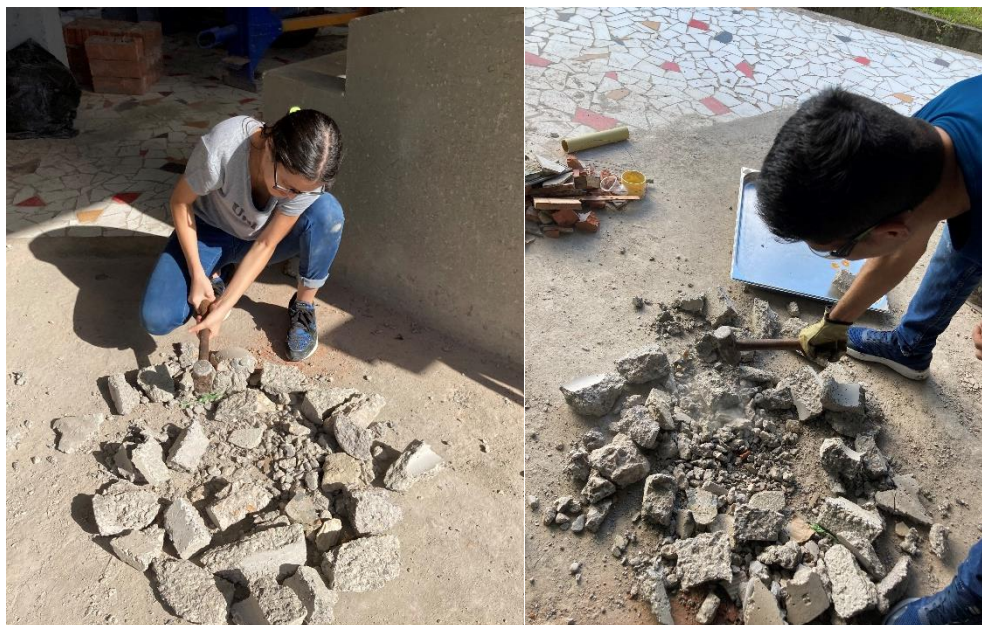
Ilustración 9-3. Proceso de triturado manual del material Fuente: Elaboración Propia
