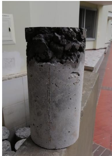
Ilustración 12-7. Patología de porosidad en muestra de espécimen Fuente: Elaboración Propia
