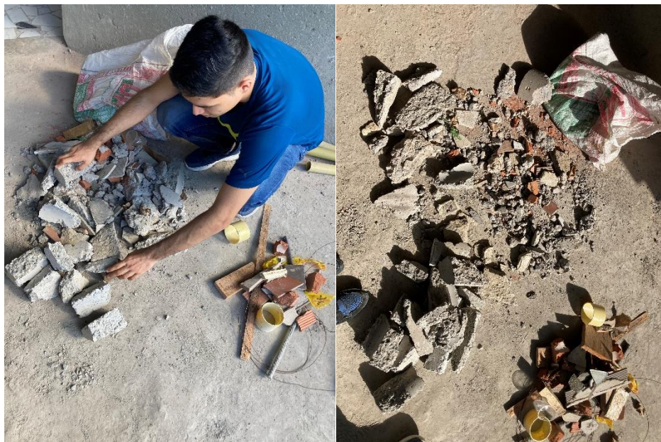
Ilustración 9-2. Muestra fotográfica clasificación manual RCD Fuente: Elaboración Propia
