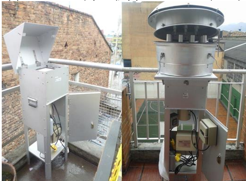
Imagen 12. Equipo muestreador PST (izquierda), equipo muestreador PM10 (derecha).
