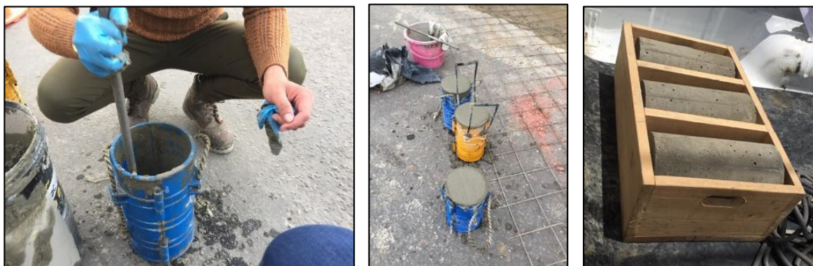
Ilustración 20:Elaboración en obra de Cilindros en concreto- Resistencia 3000PSI.
