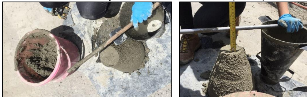
Ilustración 19: Ensayo de Asentamiento del Concreto (SLUMP).
