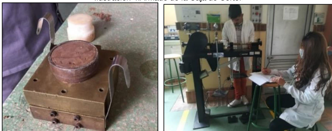
Ilustración 4: Armado de la Caja de Corte.
