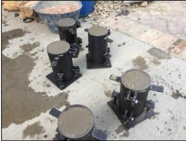
Ilustración 12:Elaboración de cilindros en concreto.
