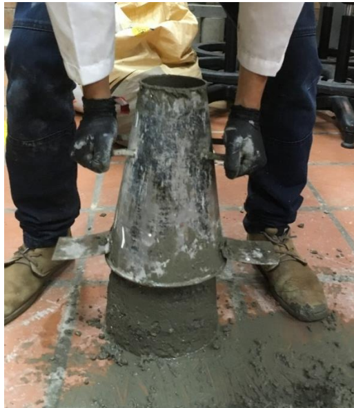
Ilustración 9. Ensayo de asentamiento del concreto.
