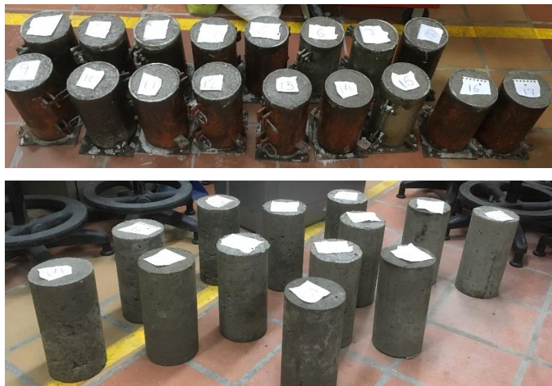
Ilustración 11. Cilindros fundidos y desencofrados.
