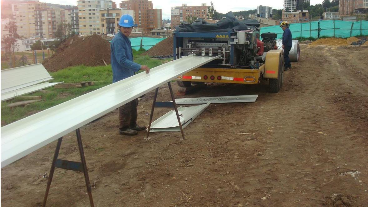
Fotografía 4: Maquina KR-24, fabricación de tejas.
