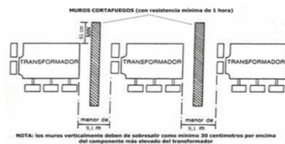
Figura 28. Especificaciones de Muros Cortafuegos
