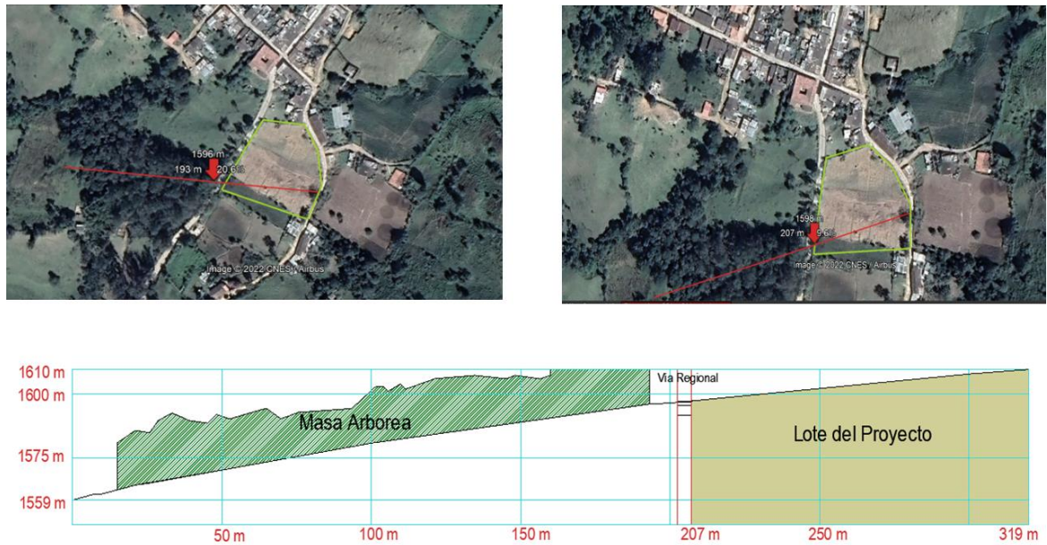
Figura 33. Pendiente transversal sur del lote
