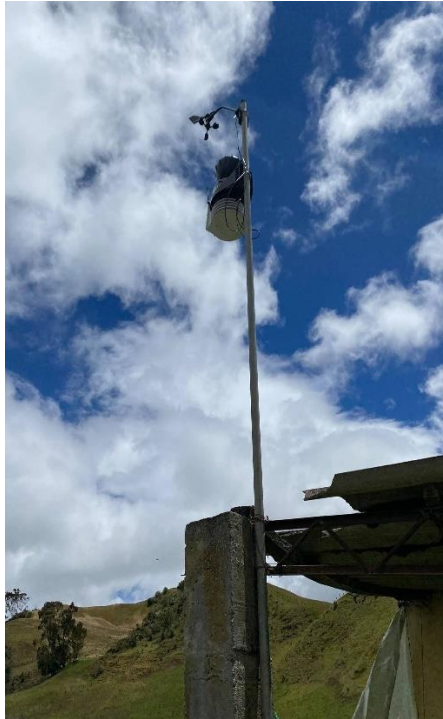
Fotografía 6. Medición velocidad del viento con velocímetro.
