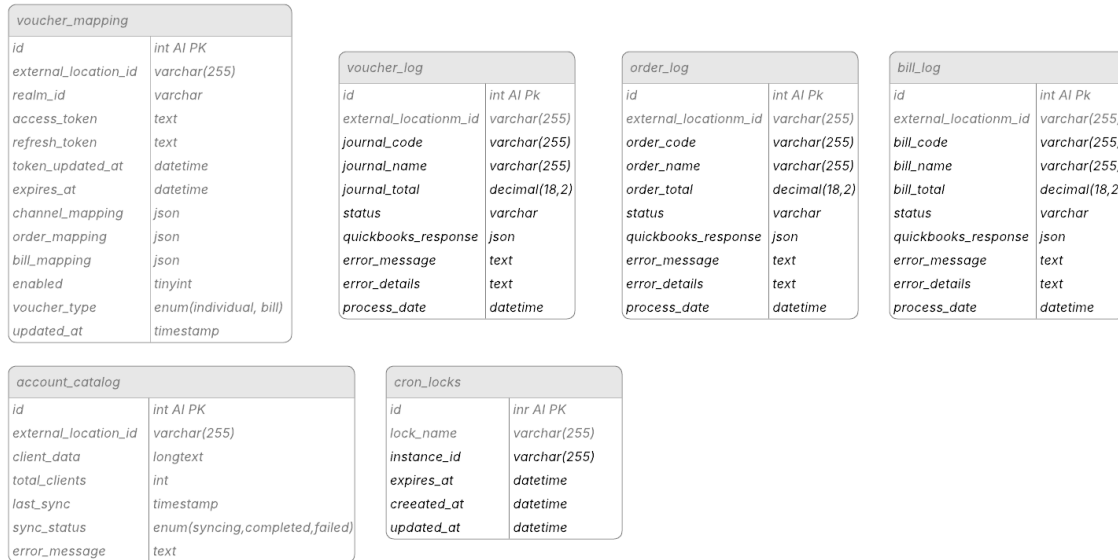
Figura 10. Modelo de datos de la integración con QuickBooks
