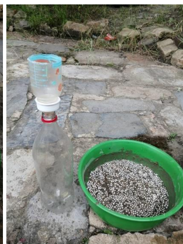
Imagen 14, 15, 16. Mezcla de los materiales arena, icopor y cascarilla de arroz para el relleno de las botellas PET. Fuente del autor.
