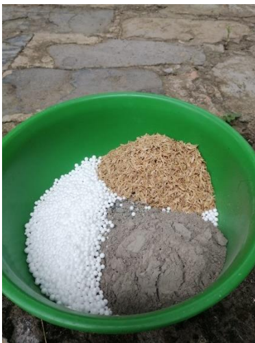
Imagen 14, 15, 16. Mezcla de los materiales arena, icopor y cascarilla de arroz para el relleno de las botellas PET. Fuente del autor.
