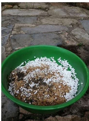
Imagen 14, 15, 16. Mezcla de los materiales arena, icopor y cascarilla de arroz para el relleno de las botellas PET. Fuente del autor.
