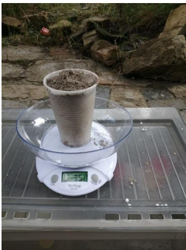
Imagen 11, 12, 13. Disposición de los materiales arena, icopor y cascarilla de arroz para el relleno de las botellas PET. Fuente del autor.
