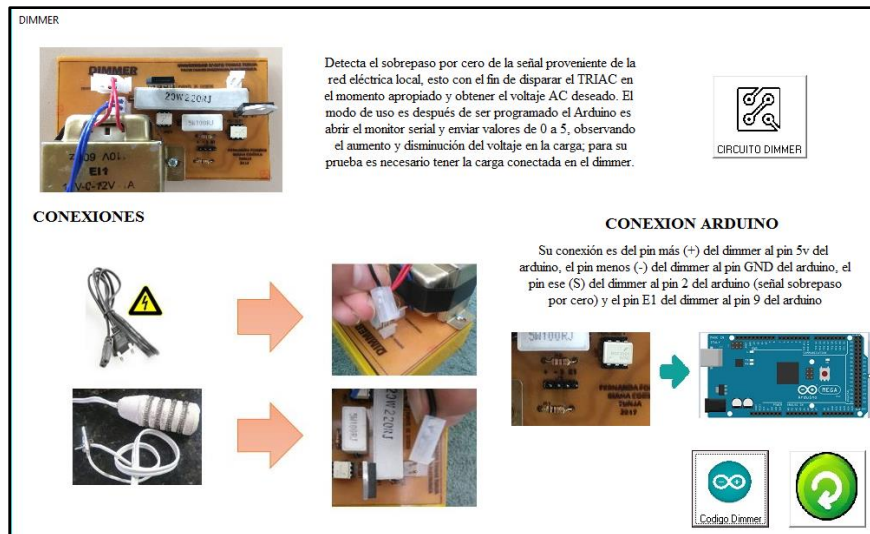
Figura 75 Funcionamiento y conexiones Dimmer. Fuente: Autor.
