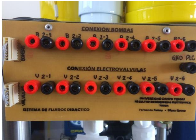
Figura 17 PCB Conexión bombas/ Conexión electroválvulas. Fuente: Autor.
