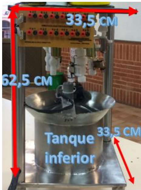
Figura 9. Dimensiones del módulo en acero inoxidable Fuente: Autor
