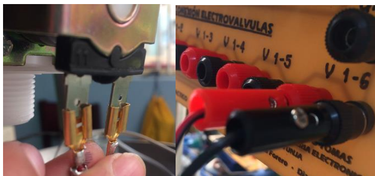
Figura 24 Conexión de electroválvulas y bombas a la PCB. Fuente: Autor.
