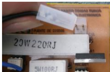
Figura 27 Conexión Carga (resistencia sumergible). Fuente: Autor.
