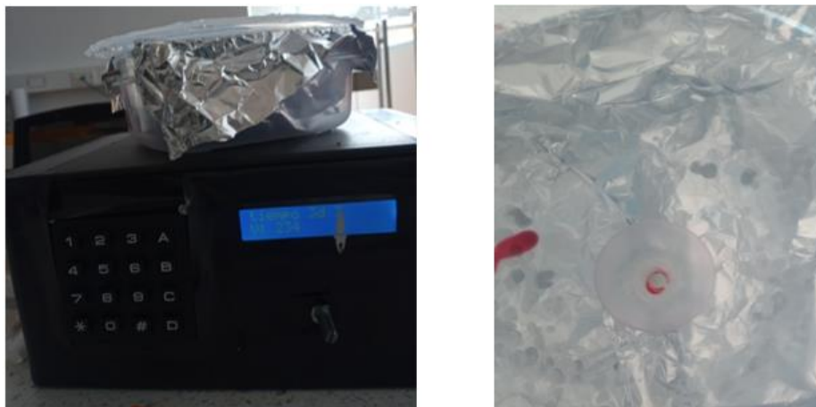
Imagen 33: Dispositivo de recubrimiento por centrifugación con la cubierta de aluminio. (Fuente: autor)
