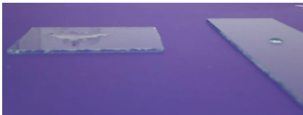
Imagen 31: Superficie hidrofílica izquierda e hidrofóbica derecha. (Fuente: autor)
