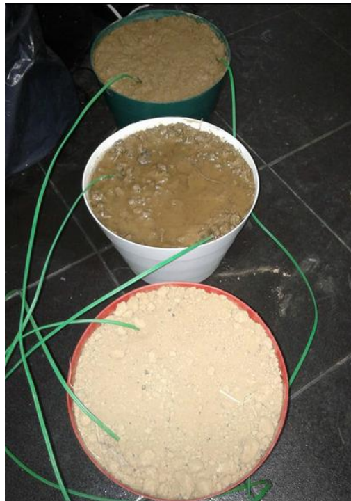
Figura27. Prueba sensores humedad de suelo
