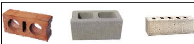
Figura 1.4.3.3-1. Tipos de unidades según material
