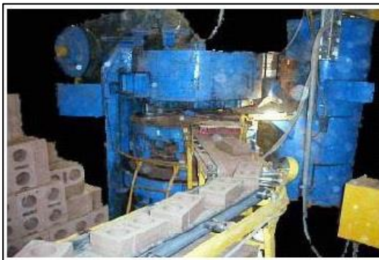
Ilustración 1.4.2-1. Proceso de prensado de unidades de mampostería
