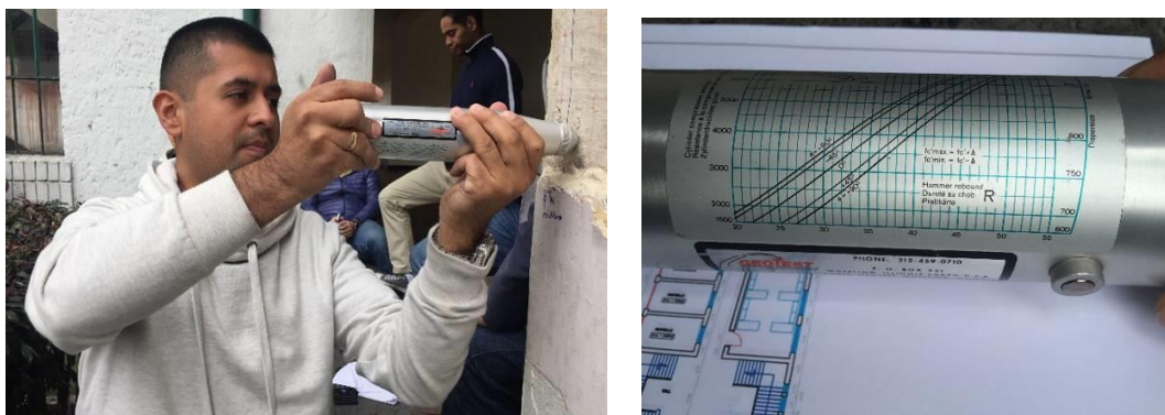
Figura 36. Lectura de impactos con martillo de Schmitd y correlación con f'c aparente.
