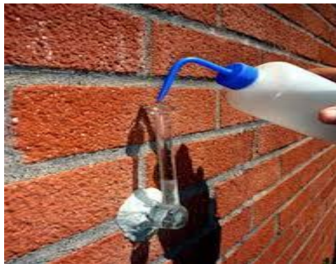
Figura 69. Ensayo de absorción con tubo Karsten. Imagen de referencia
