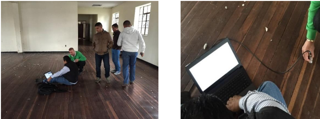
Figura 56. Excitación del piso, acelerómetros y captador de señal.
