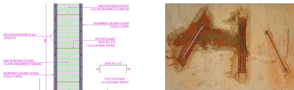
Figura 91. Propuesta de intervención para muros de mampostería.
