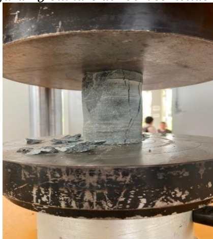
Figura 15 Cilindro de 10cm sometido a compresión
