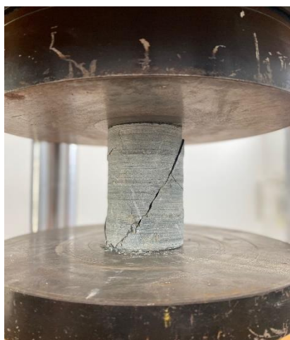
Figura 16 Cilindro de 13cm sometido a compresión
