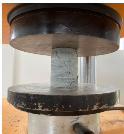
Figura 14- Cilindro 8cm sometido a compresión
