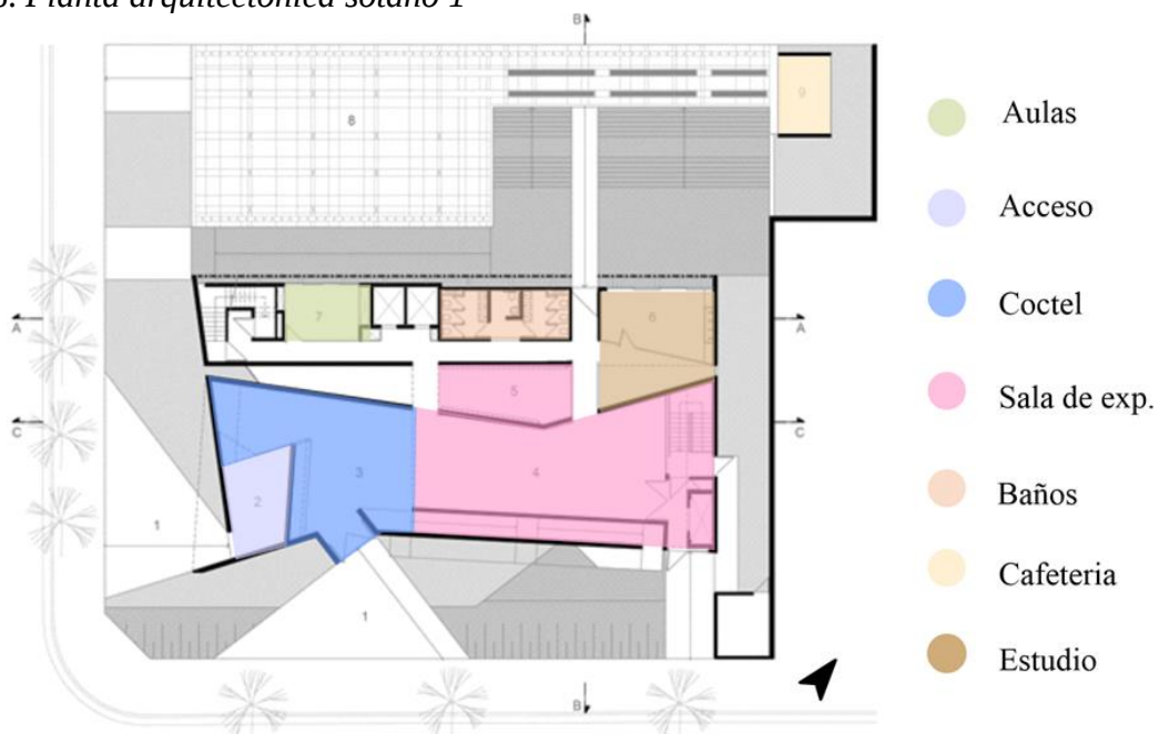
Figura 6. Planta arquitectónica sótano 1
