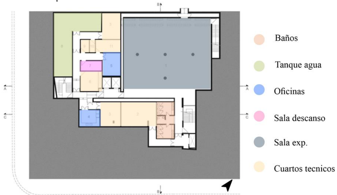
Figura 8. Planta arquitectónica sótano 3
