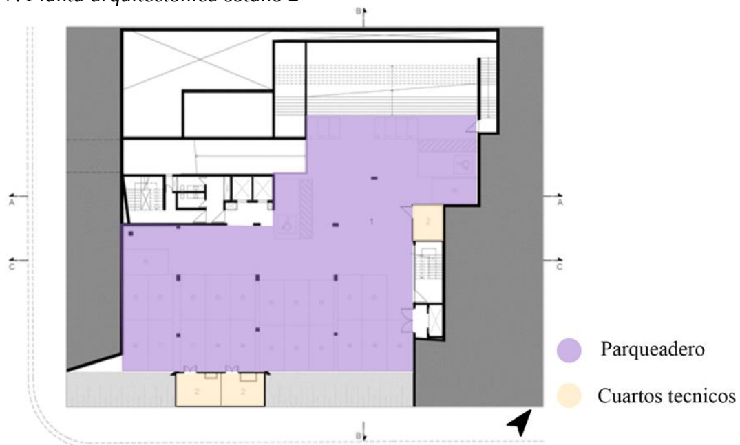
Figura 7. Planta arquitectónica sótano 2
