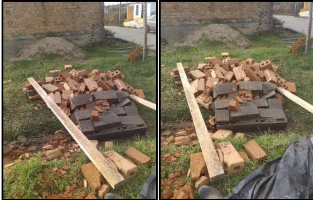
Imagen 43. Falla del murete de bloques ecológicos a 1200 kg
