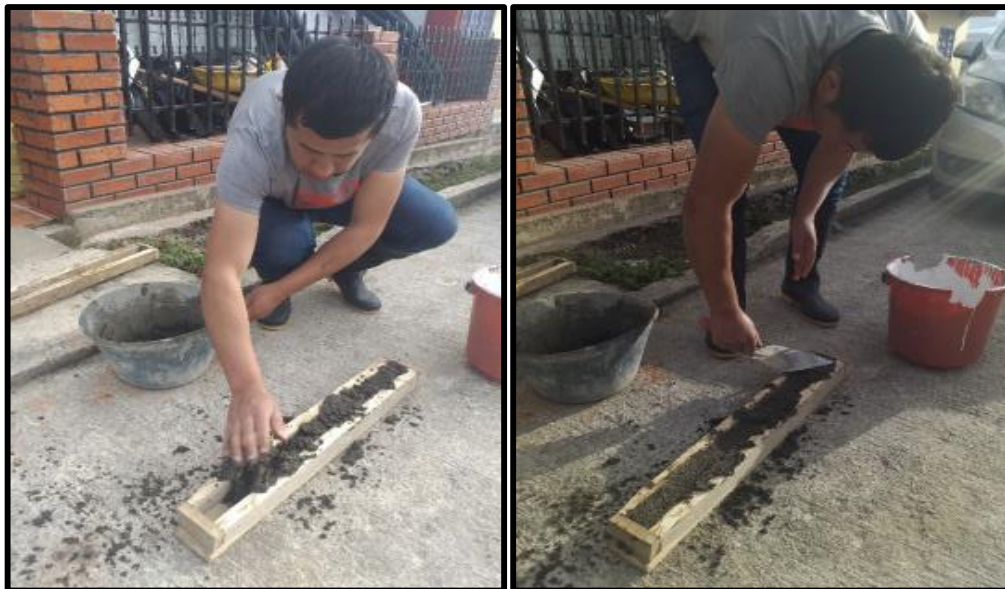
Imagen 21. Ensayo de retracción de los material fino. Elaboración de caja de madera y llenado de material fino
