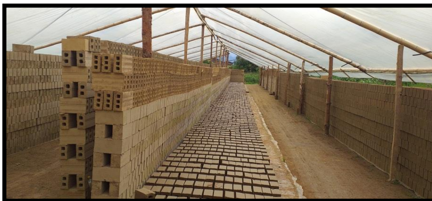
Imagen 13. Apilamiento de ladrillo crudo de arcilla en etapa de secad. Fuente esta investigación. 2019
