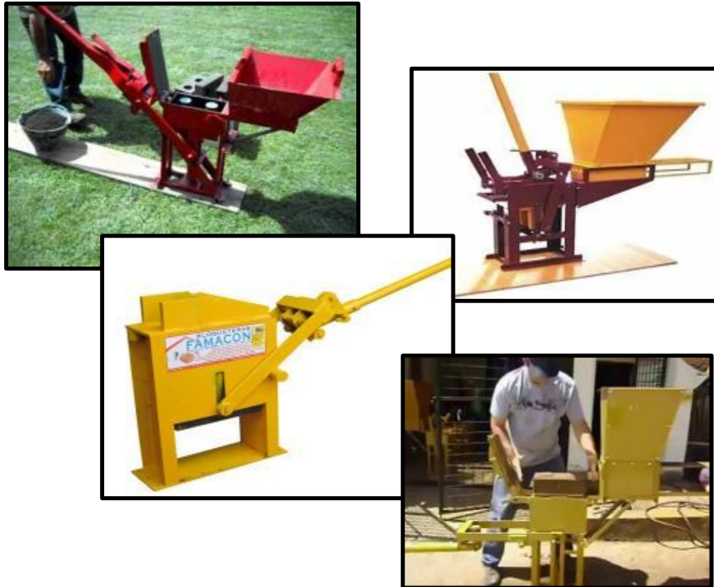
Imagen 15. Tipos de máquinas manuales para elaboración de ladrillos con suelo cemento comprimidos
