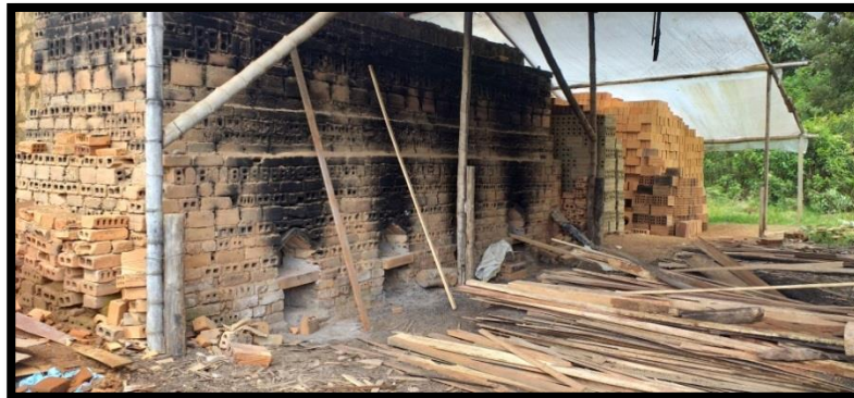
Imagen 12. Hornos de quema de ladrillo (utilización de madera como material combustible). Fuente esta investigación. 2019.
