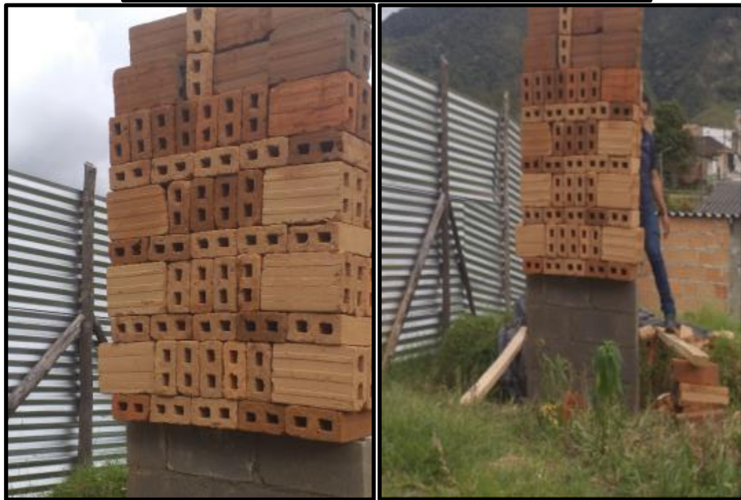
Imagen 42 Aplicación de cargas paulatinamente para determinar la compresión del murete de bloque ecológico
