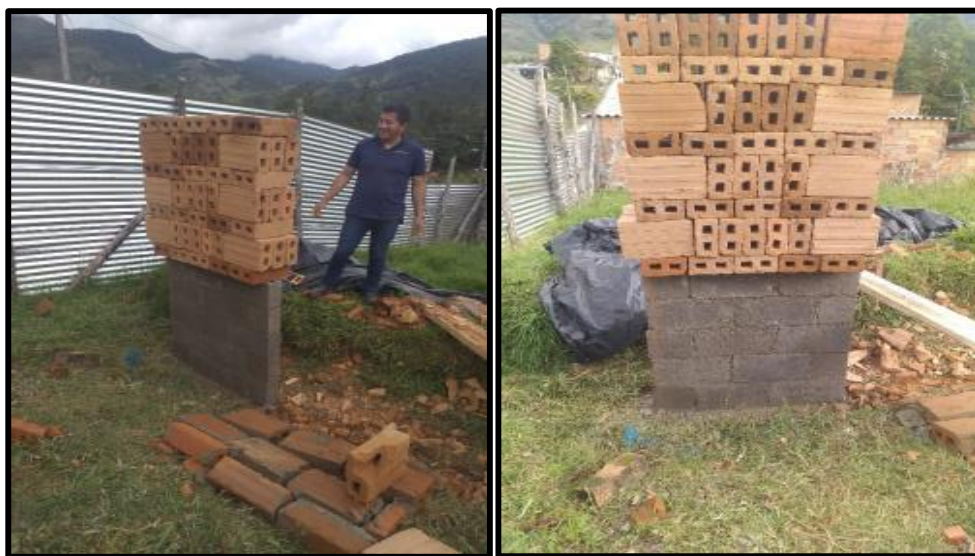
Imagen 41. Aplicación de cargas para determinar la compresión del murete de bloque ecológico
