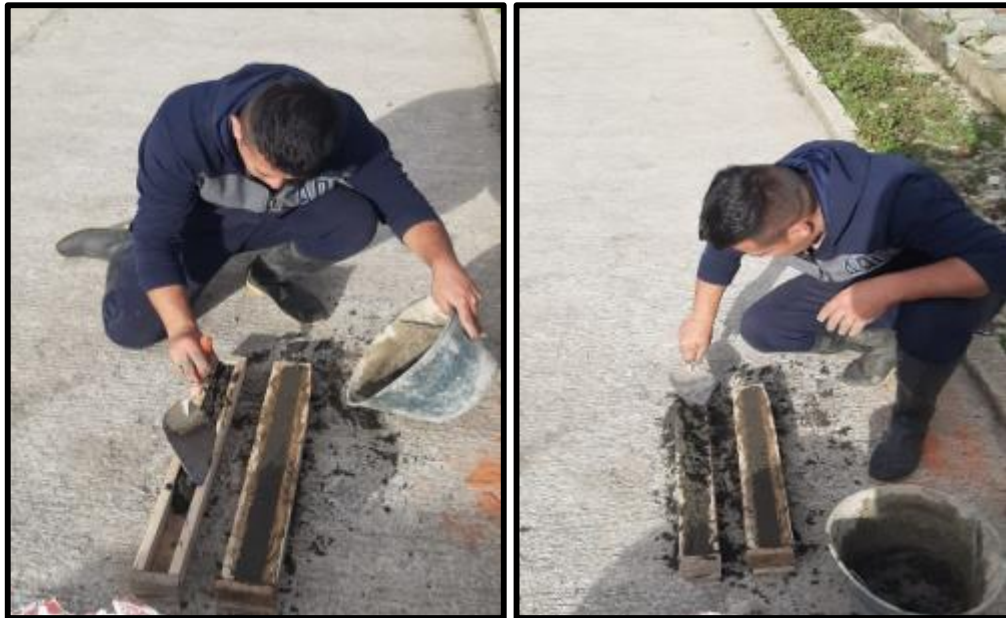
Imagen 22. Ensayo de retracción de los material fin. Compactación y alisado de superficie
