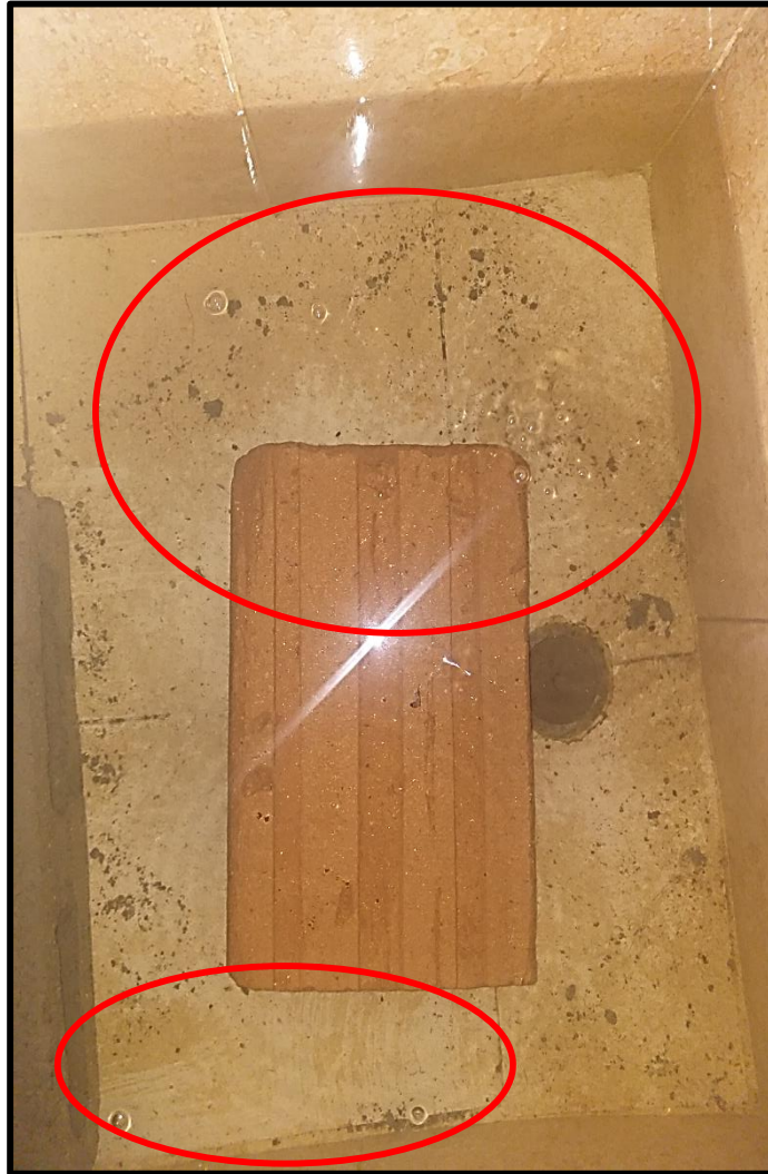
Imagen 33. Comportamiento del ladrillo seco en el proceso de absorción.
