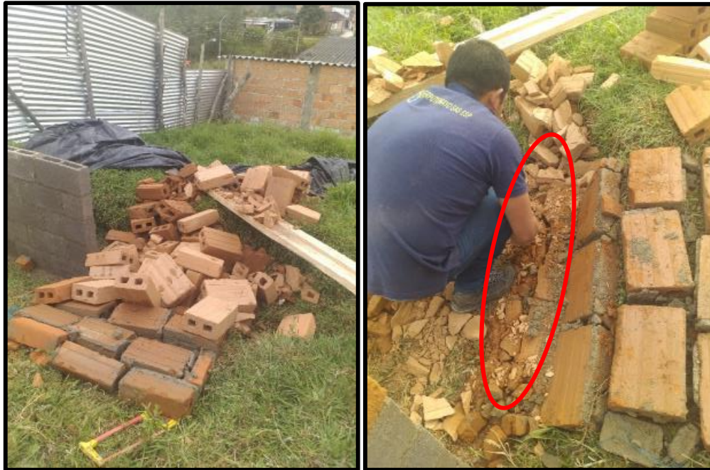
Imagen 40. Falla de murete de ladrillo de arcilla a los 900 kg
