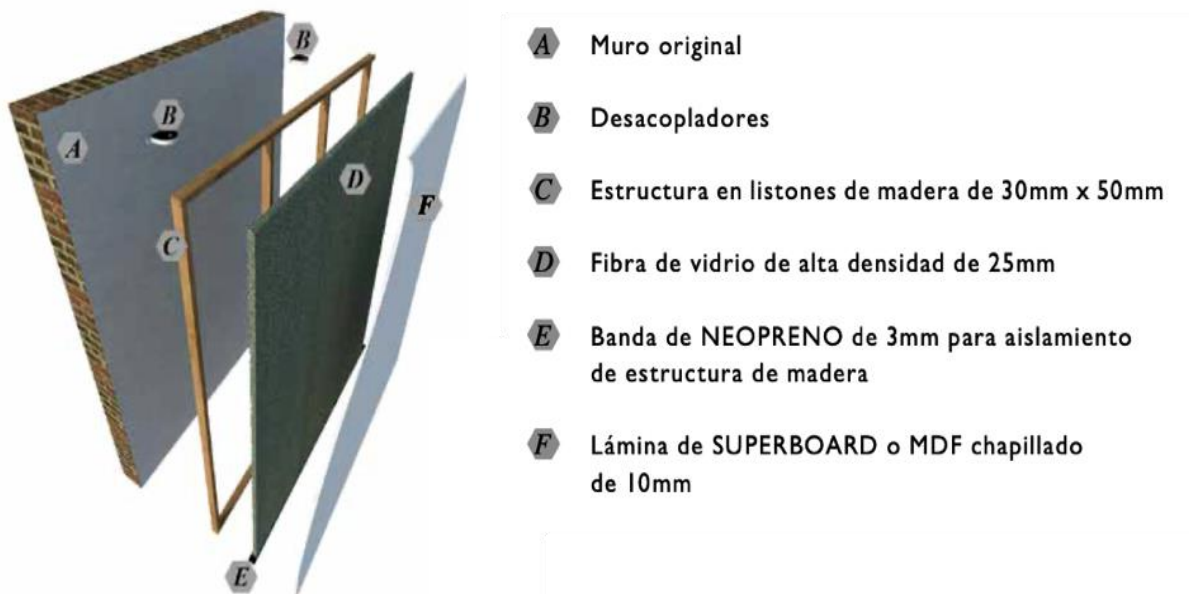
Figura 125. Detalle de las paredes aisladas
