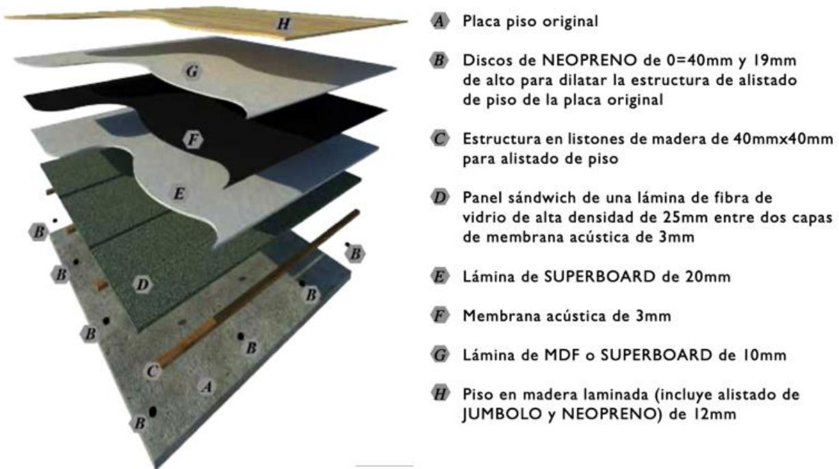
Figura 124. Detalle del piso flotante
