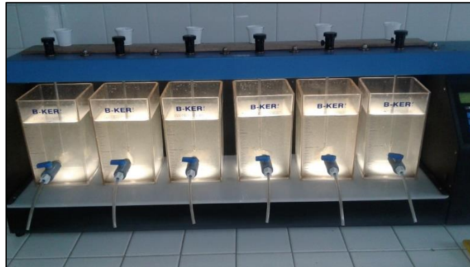
Figura 29: Test de jarras- PTAP Corinto
