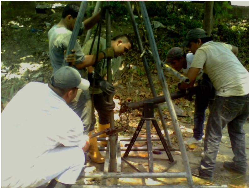
FOTO 16. Inicio de la inserción de los tubos shelvy, para determinar el perfil estratigráfico
