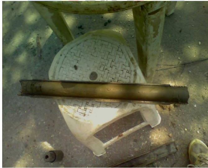
FOTO 20. Arcilla con limo, gris carmelita, humedad media
