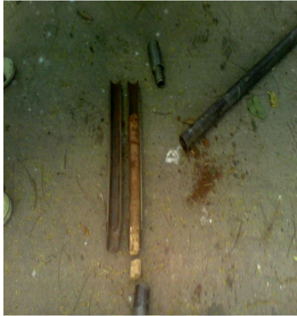
FOTO 19. Arcilla con limo, carmelita rojizo, humedad media
