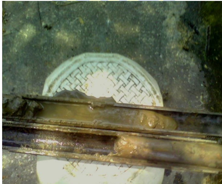
FOTO 18. Arcilla limosa carmelita, consistencia media, plasticidad baja
