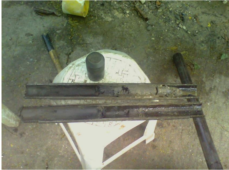
FOTO 17. Muestra del material, limo con arcilla, algo de arena fina, trazas orgánicas, carmelita, humedad baja.
