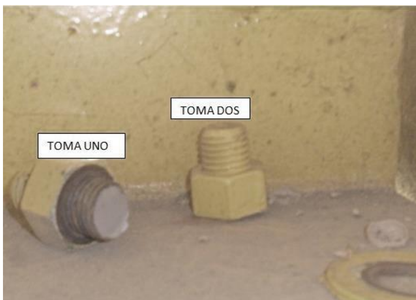
Figura 25. Evidencia de dos cortes de pernos en sitio
