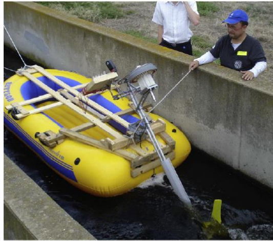
Figura 11. Prueba a turbina variable
