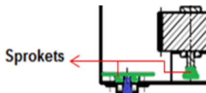
Figura 58. Ubicación del sistema de transmisión secundario
