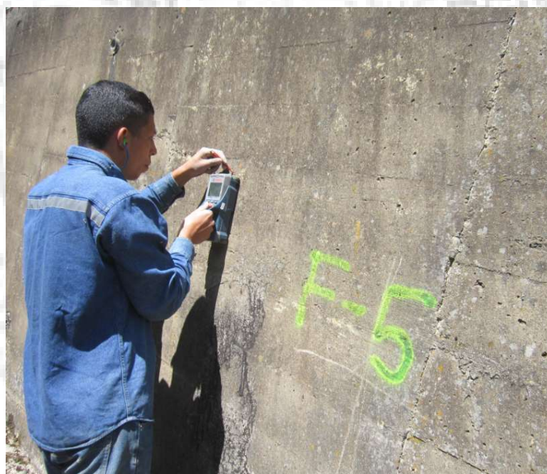
Fotografía. 99. Detección acero de refuerzo en muro del vertedero. Fuente: Consorcio Embalses CAR, 2020.
