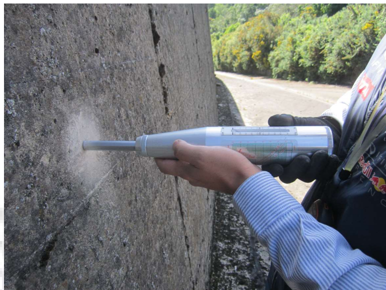
Fotografía. 95. Esclerometría en muro margen izquierda vertedero de excesos. Fuente: Consorcio Embalses CAR, 2020.
