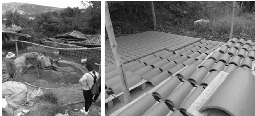
Figura 22. Proceso de elaboración de arcilla para la elaboración de elementos constructivos Tejas y bloques de tierra en proceso de secado. Fuente Autores del Proyecto
