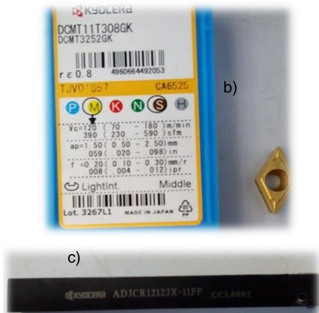
Figura 16. a) Geometría herramienta refrentado y desbaste b) Inserto c) Porta inserto
