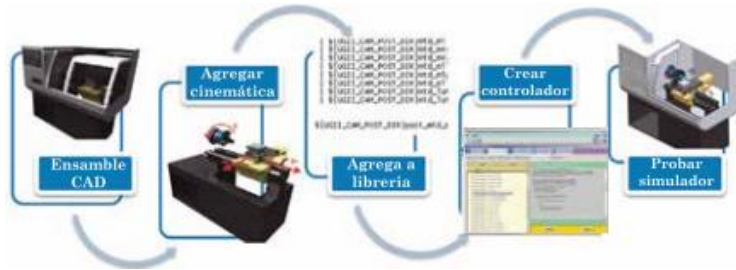
Figura 1. Diagrama de flujo para implementar CAM.
