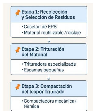
Figura 3. Etapas de compactación y trituración
