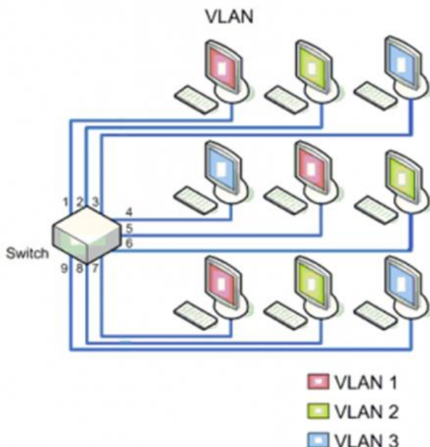
Fig. 4. Esquema red VLAN. Fuente. internetpasoapaso.com
