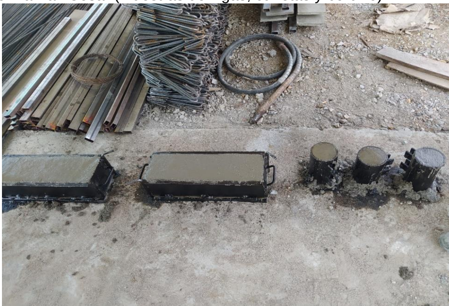
Figura 29. La Paz Cesar (Muestras de vigas, cunetas y bordillo).
