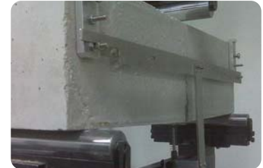
EN 14651 Flexural Test
