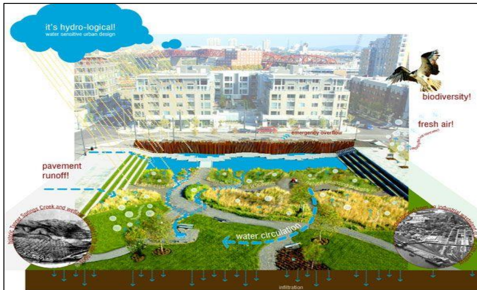
Figura 11. Funcionamiento humedal artificial en Tanner Spring Park
