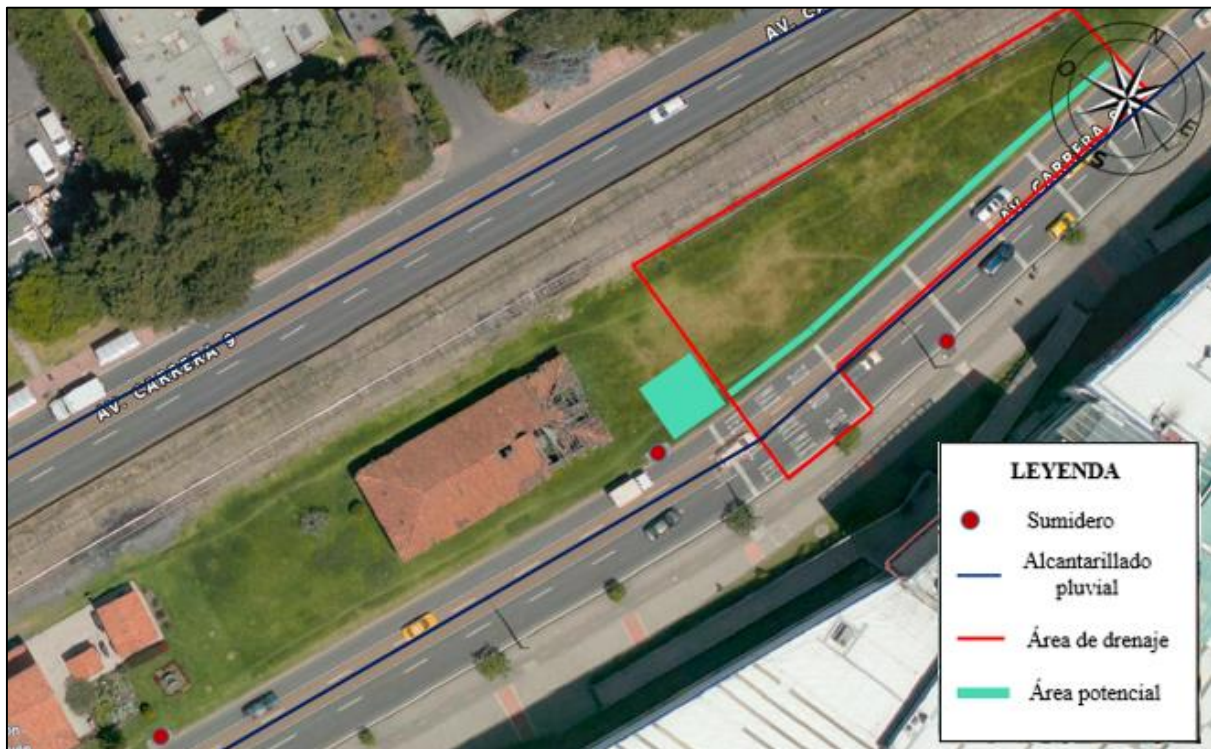
Figura 23. Mapa áreas de drenaje para zona potencial del primer tren en zanja filtrante que conecta con primer tanque de atenuación para aguas lluvias.
