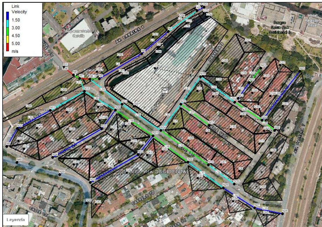
Figura 41. Velocidad de flujo en colectores en el área simulada para un periodo de retorno de 3 años
