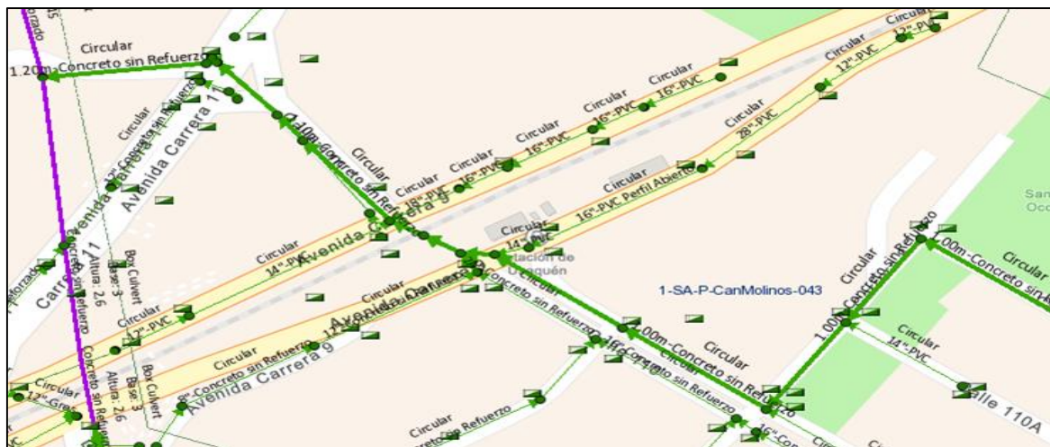
Figura 18. Red de alcantarillado pluvial existente en el área de diseño
