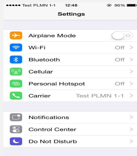
Figura 19. Conexión establecida de terminal con red Test PLMN 1-1.
