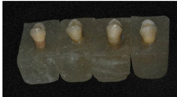
Figura 2. Muestra de dientes extraídos colocados en bloques de resina acrílica.
