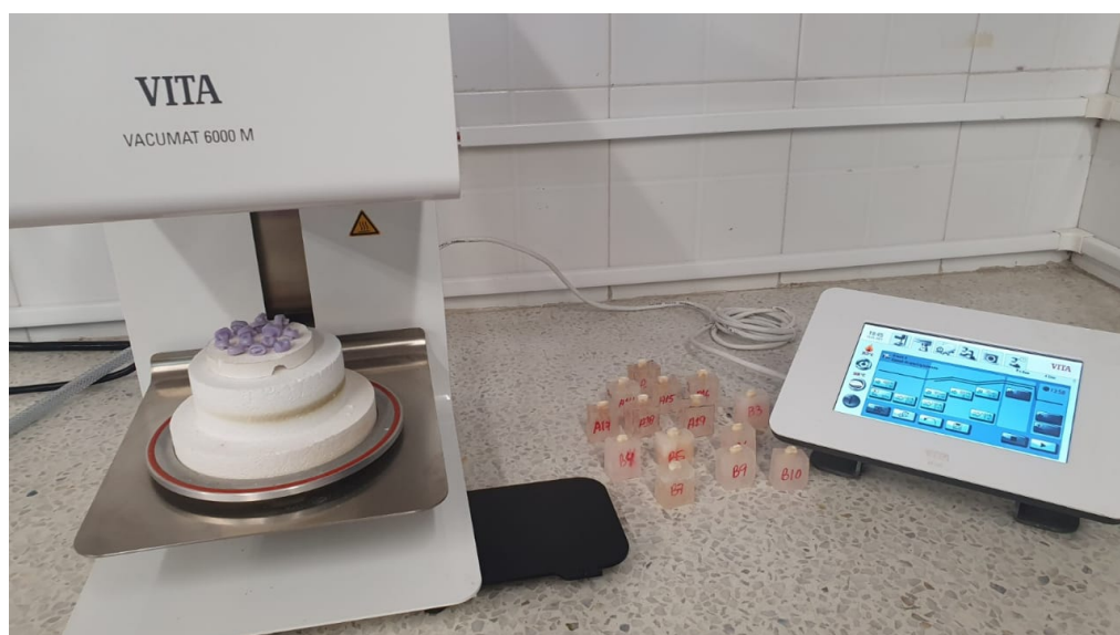
Figura 8. Muestra de proceso de cristalización de las restauraciones con el Horno Vita.
