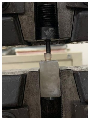
Figura 13. Muestra alineada en el dispositivo universal de pruebas.
