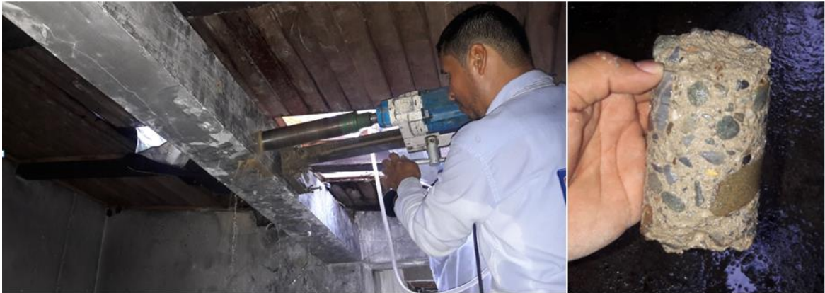
Figura 12. Toma de muestra mediante extracción de núcleo para ensayo a la compresión. fuente Rocha, L. Ruiz, D (2018)
