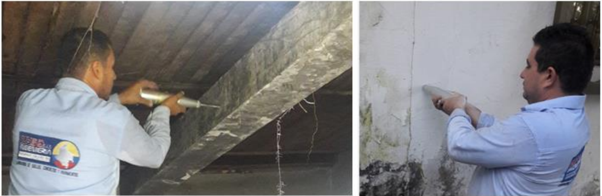
Figura 16. Ensayo de esclerometría. fuente Rocha, L. Ruiz, D (2018)
