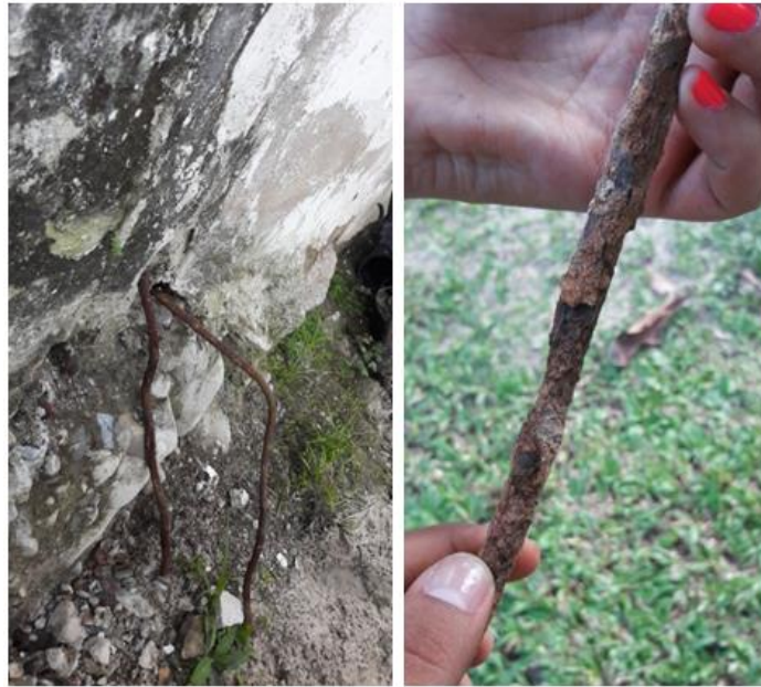
Figura 10. Toma de Muestra 3, acero expuesto al medio ambiente, fuente Rocha, L. Ruiz, D (2018)
