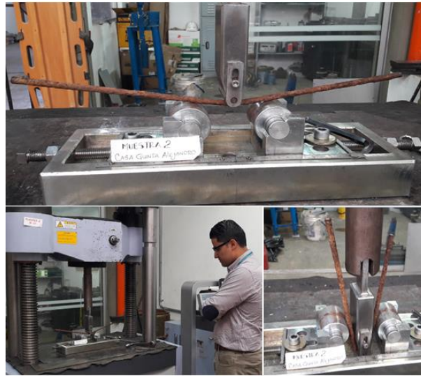
Figura 9. Ensayo de doblamiento, fuente Rocha, L. Ruiz, D (2018)
