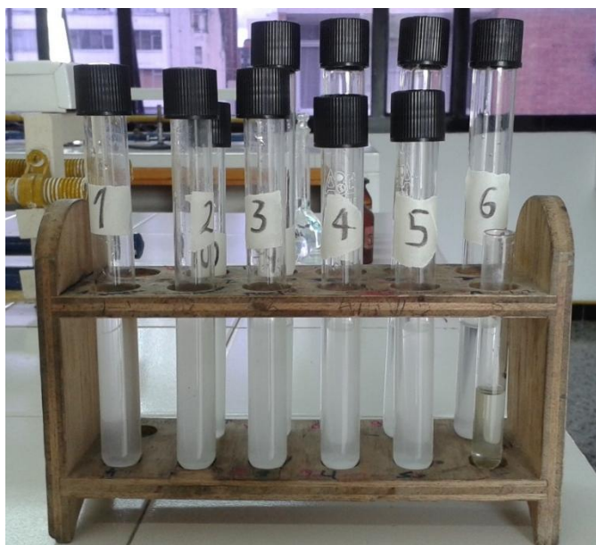
Figura No. 21 10 Tubos de soluciones del Patrón de Mc Farland.
