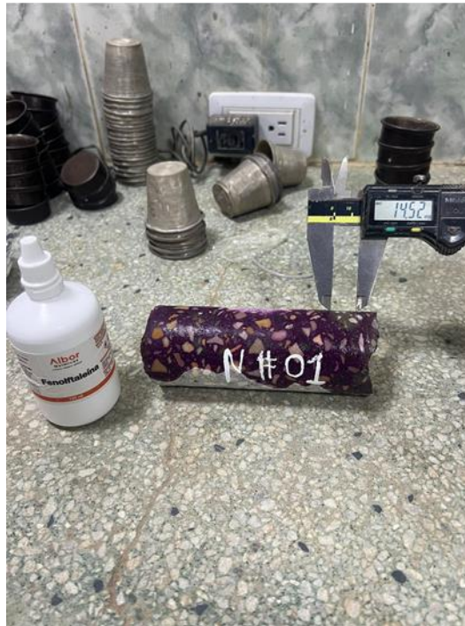
Figura 58: Carbonatación Núcleo Columna 4 – Eje 3, Costado Sur
