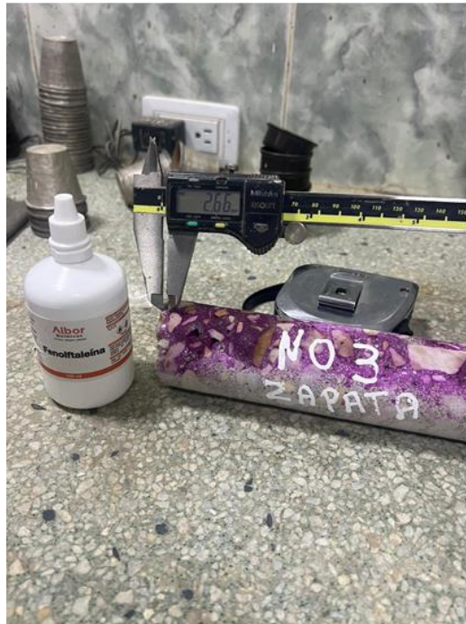
Figura 60: Carbonatación Núcleo Zapata 3 – Eje 4, Costado Sur
