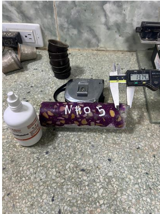
Figura 62: Carbonatación Núcleo Columna 3 – Eje 6, Costado Sur
