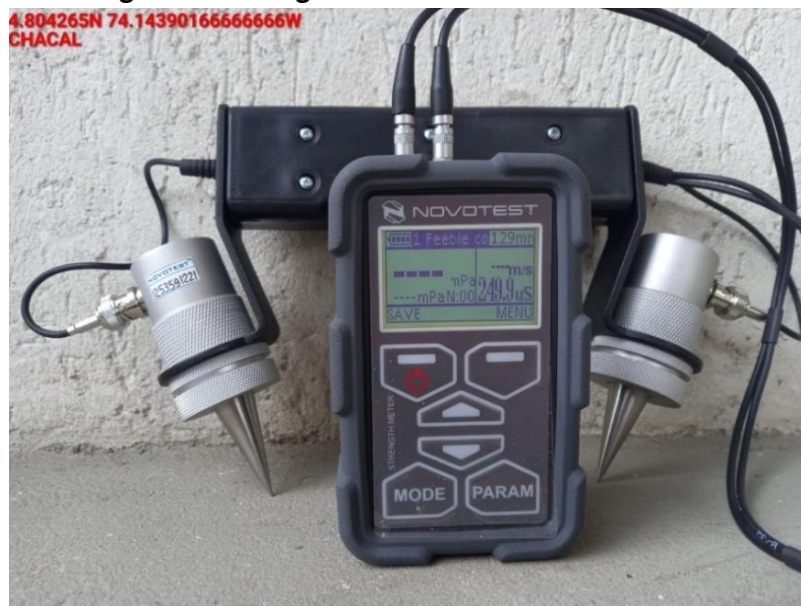
Figura 20: fotografía Ultrasonido NOVOTEST.
