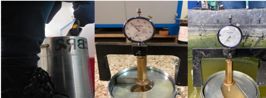
Figura 19. Ejecución ensayo CBR.
