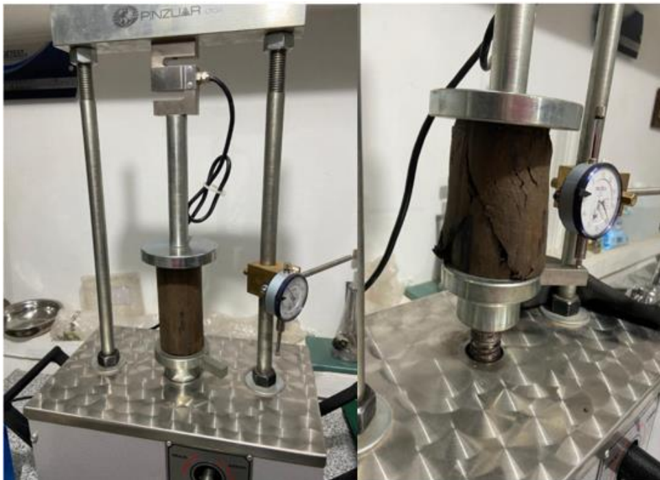
Figura 16. Ejecución de ensayo de compresión inconfinada.
