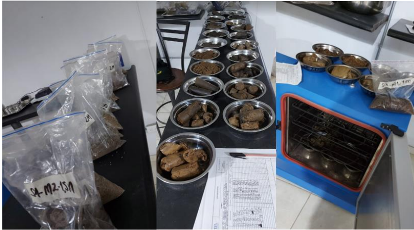
Figura 6. Ejecución ensayo de laboratorio y humedad natural.
