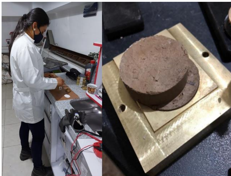
Figura 11. Ejecución ensayo corte directo.
