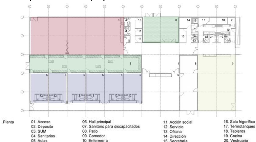
Figura 61. Planta arquitectónica del proyecto
