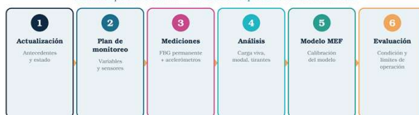
Figura 3. Metodología de monitoreo periódico del IMT lecho del puente atirantado El Carrizo. Fuente: elaboración propia a partir de IMT (2024).
