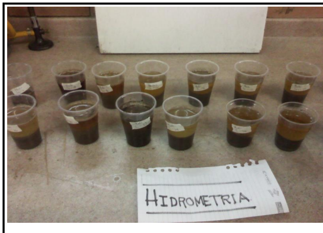
Foto No.: 10 Descripción: Preparación muestras para laboratorio de hidrometría
