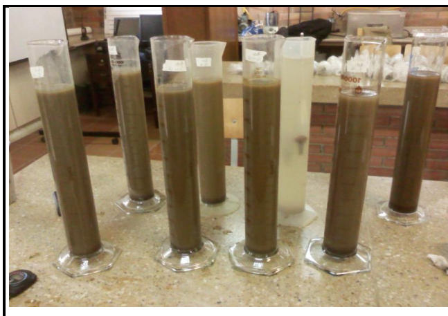
Foto No.: 11 Descripción: Hidrometrías
