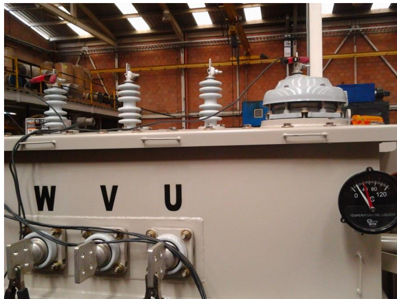
Figura. 9 Medición de resistencia entre terminales W – U. Fuente: Autor.
