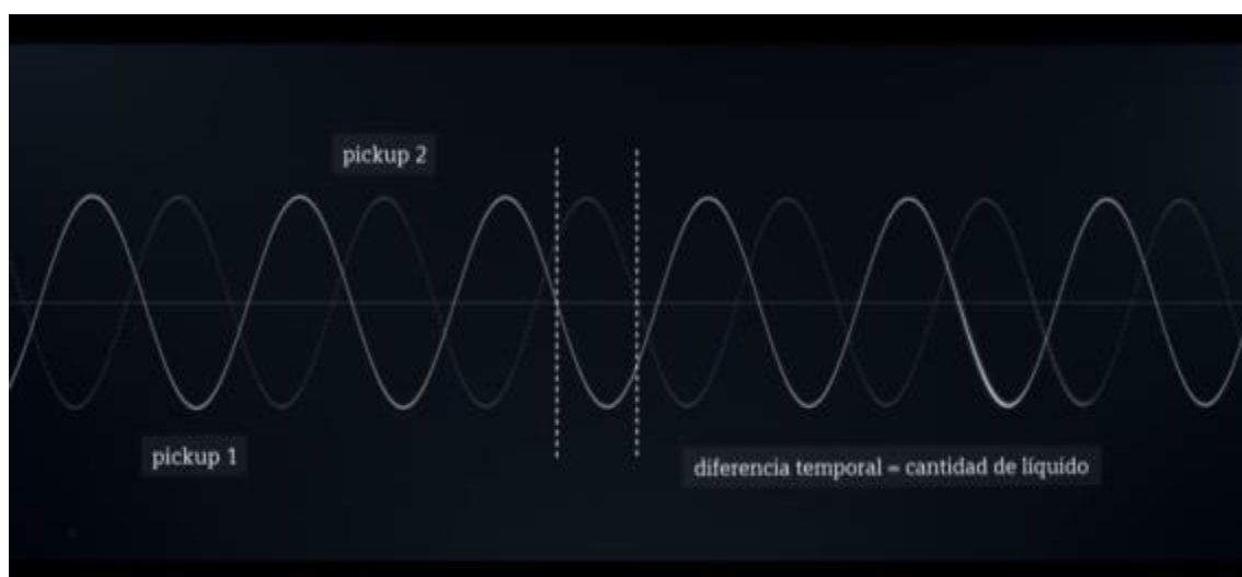
Figura. 35 Señal de respuesta de un medidor tipo Coriolis. Fuente: Siemens Flujoómetro Sitrans FC-430.
