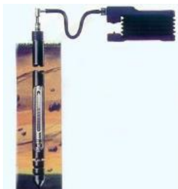
Figura. 41 Sonda y extractor de toma muestras para un sistema de medición.
