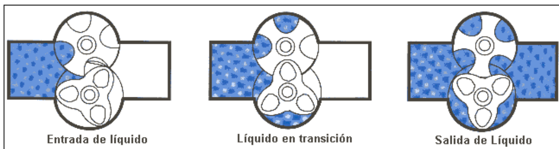
Figura. 30 Funcionamiento MDP tipo bi-rotor. Fuente: FMC Technologies paper TP 0A014
