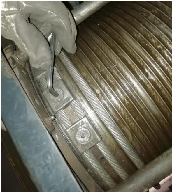
Figura 13. Elementos de fijación.
