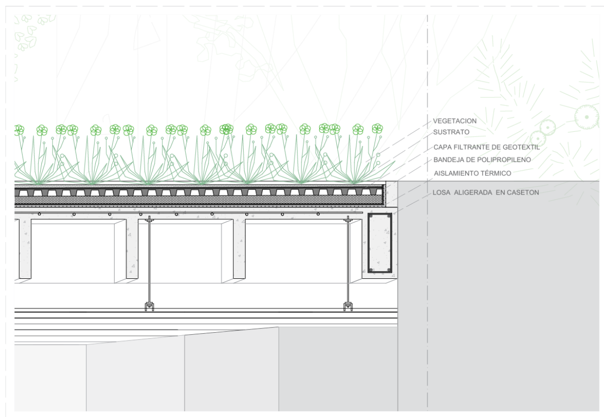
Imagen 84. Detalle de cubierta verde. Autores
