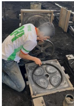
Figura 10. Moldeador de volantes desarrollando la subtarea de extraer el modelo y realizar los detalles al molde que queda.
